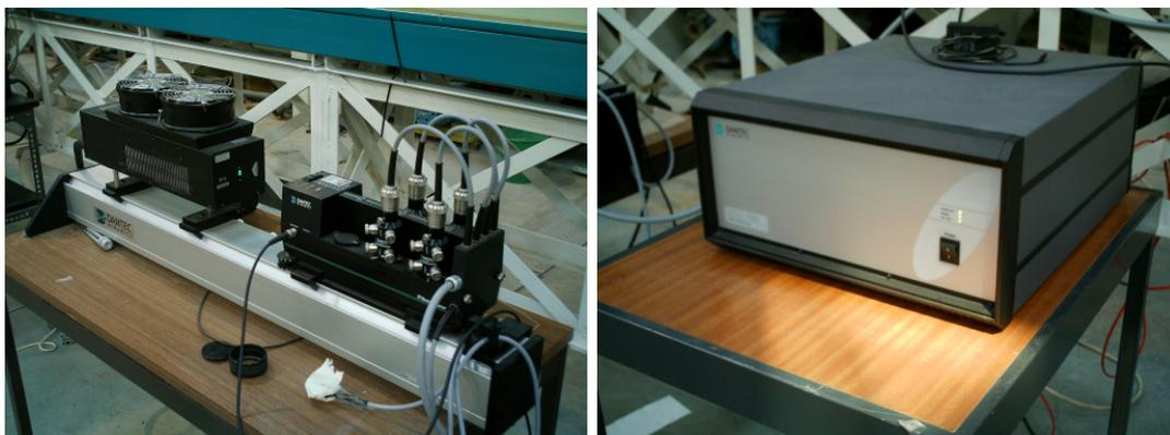
Figura 4.19: Foto do sistema de laser Doppler e o processador BSA.
