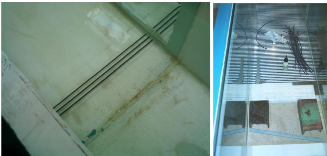
Figura 4.3: Rugosidade sendo testada no canal e a ilustração do processo utilizado para garantir a perpendicularidade ao escoamento.
