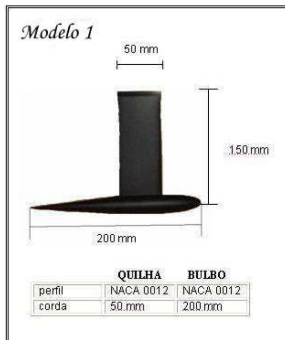
Figura 4.2: Esquema simplificado mostrando a quilha montada em sua posição de ensaio.
