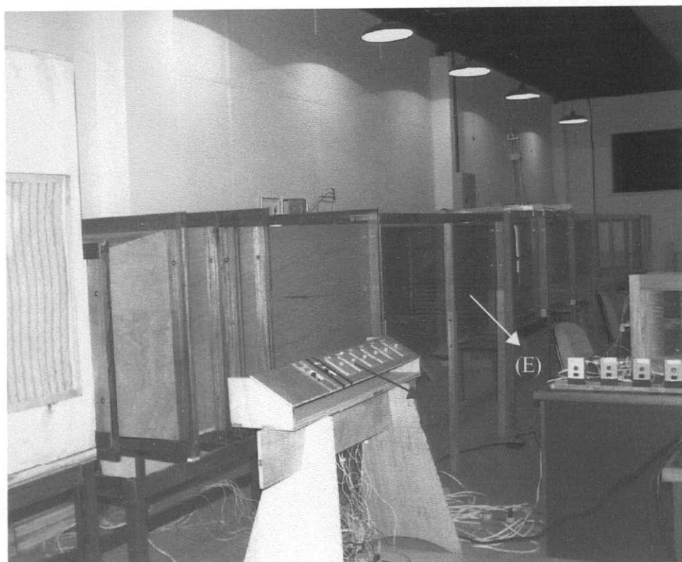
Figura 4.1.2 – Foto do Túnel de Vento do laboratório de Mecânica da Turbulência - COPPE/UFRJ. Seção de testes com 9 metros de comprimento.
