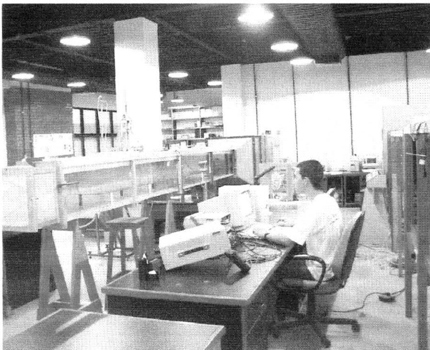
Figura 4.3.2.2 – Foto do túnel utilizado na calibração de velocidade. (seção de 0.3 x 0.3 x 3 ) m.
