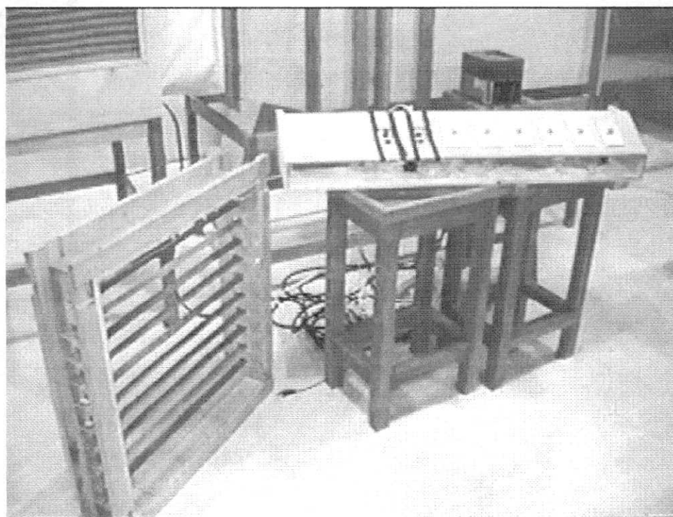
Figura 4.2.3 – Foto da seção de estratificação com os potenciômetros.
