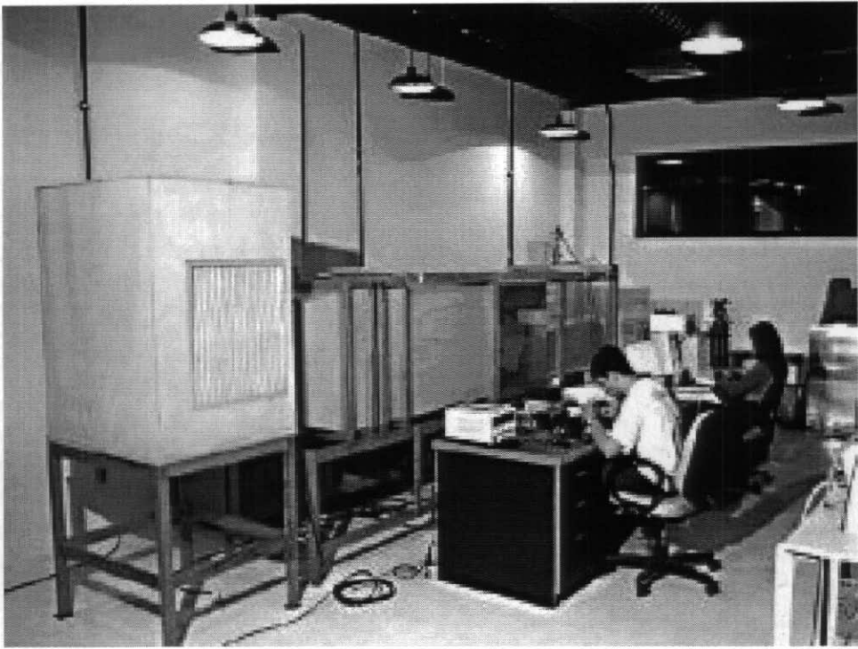
Figura 3.1 – Túnel de Vento da COPPE/UFRJ com seção de testes de 3 metros de comprimento. Em primeiro plano, o compartimento do ventilador.
