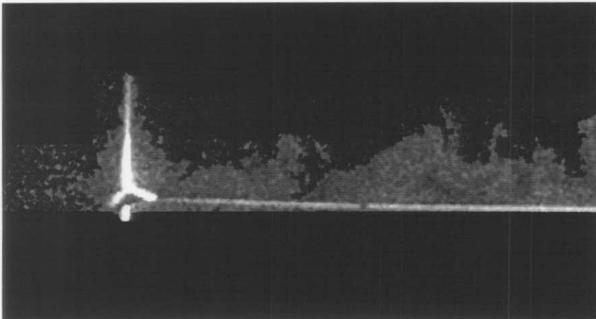
Figura 4.34 – Tomada visual do escoamento ao redor da floresta de barras circulares de 160 mm.
