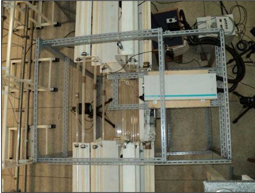
Figura 4-28. Elementos para a medição com a técnica de Velocimetria por Imagem de Partículas.
