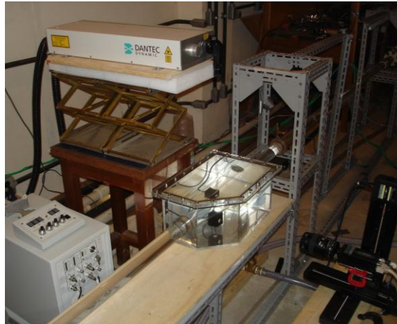
Figura 4.12 – Posicionamento laser-câmera para aquisição de imagens no plano longitudinal central
