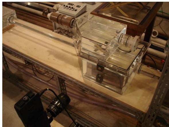
Figura 4.20 – Disposição dos aparatos para calibração do sistema LIF
