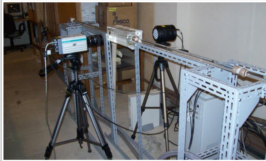
Figura 5.1: Medição com o Dimensionamento por Sombras
