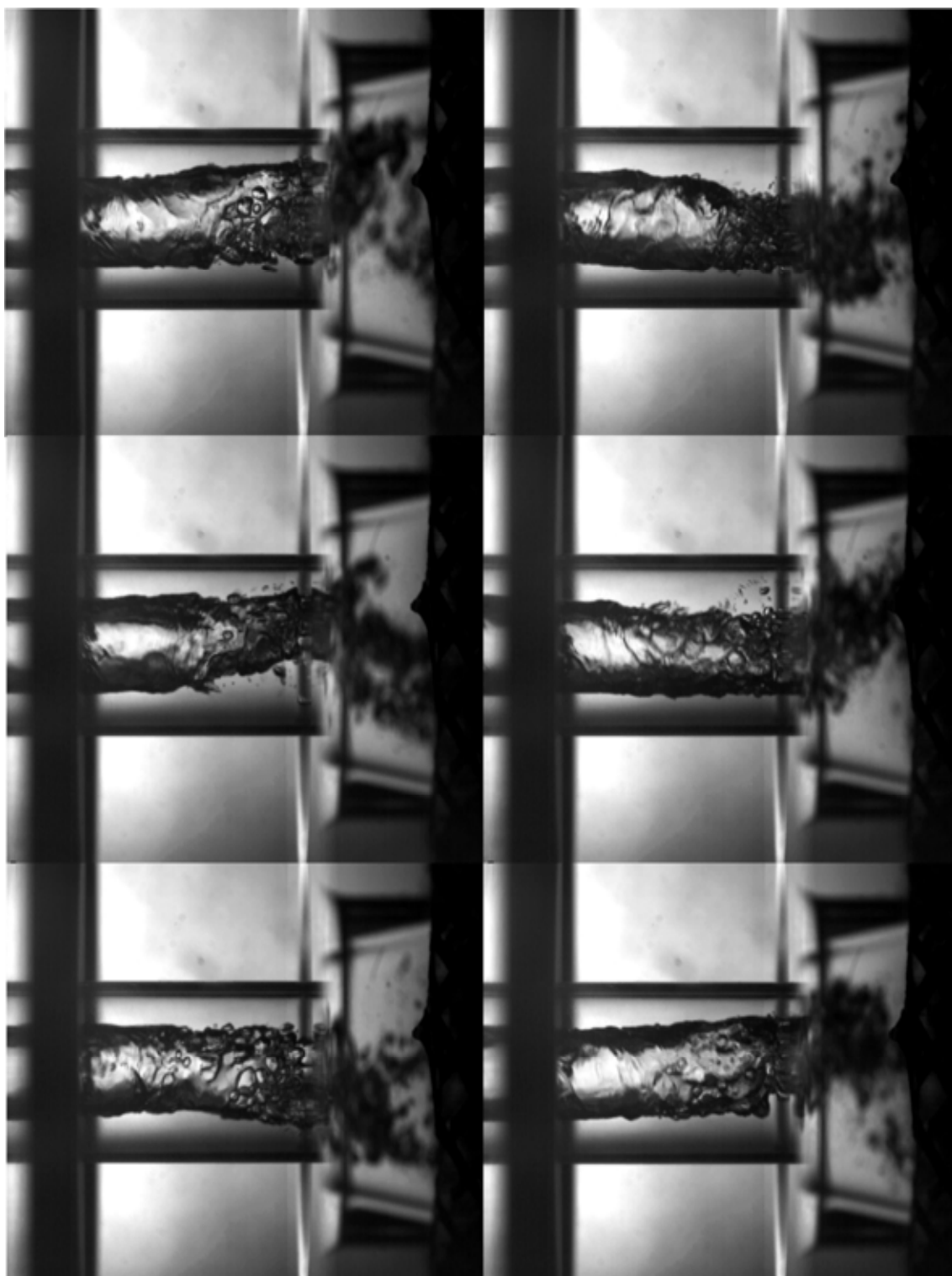
Figura 5.36: Visualização do escoamento bifásico (água/ar) na expansão existente na saída do cone.
