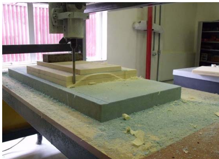
Figura 3.8: Usinagem feita com controle numérico.
