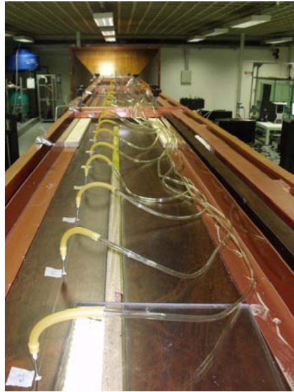
Figura 3.47: Tomadas de pressão estática no teto do túnel.
