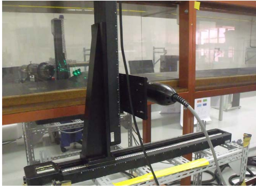
Figura 3.53: Ilustração do sistema de anemometria laser em operação e os posicionadores das sondas.
