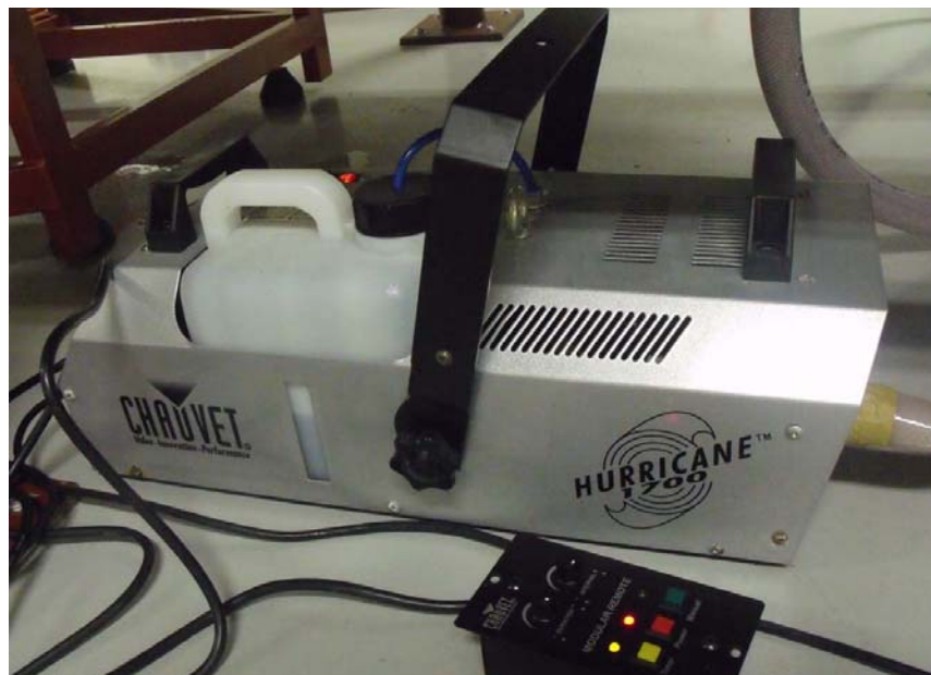
Figura 3.50: Gerador de fumaça.
